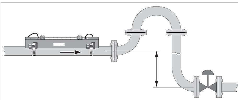
Рисунок 3-5: Нисходящий участок трубопровода длиной 5 м / 16 футов
