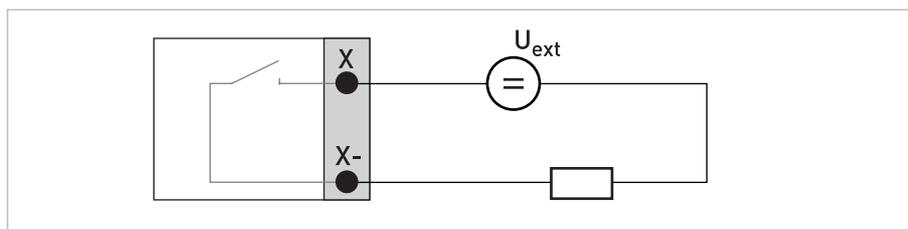
Рисунок 4-5: Пассивный выход состояния / сигнализация  $S_p$
