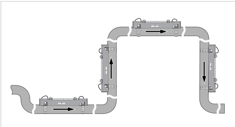
Рисунок 3-3: Допускается монтаж на вертикальных участках трубопровода
