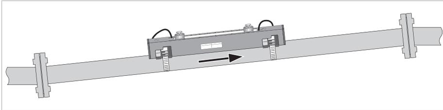
Рисунок 3-2: Горизонтальные участки трубопровода большой длины
